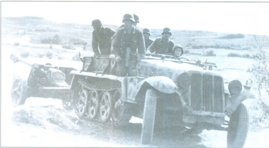
SdKfz 10 als trekker van een 7,5 cm PaK 40
