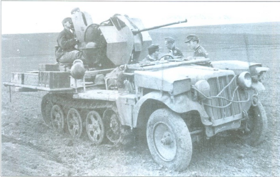
SdKfz 10/5. Let op de opvallende opbergkasten op de voorspatborden.
